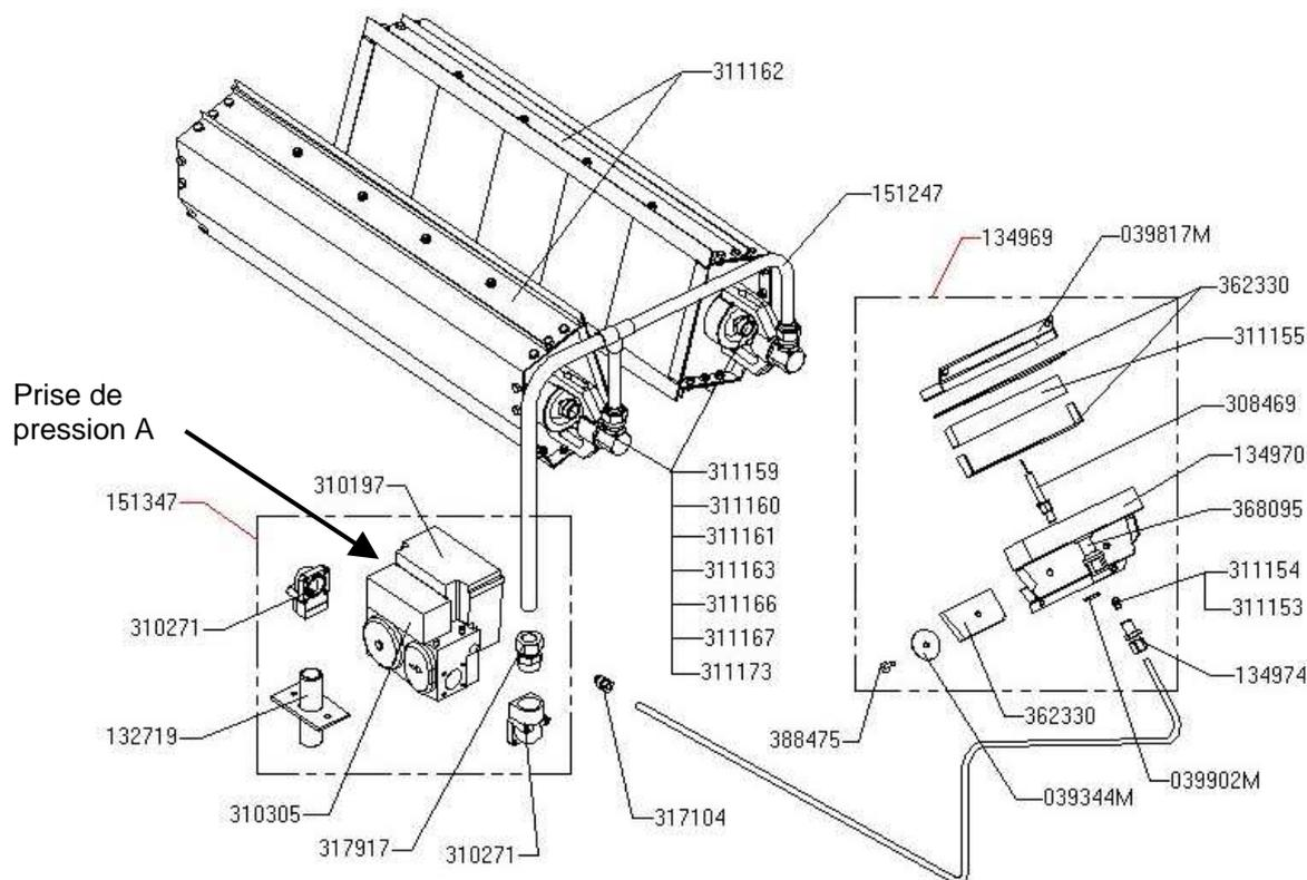
**Remarque:** La prise de pression **A** permet de contrôler la pression gaz à l'entrée de l'appareil
